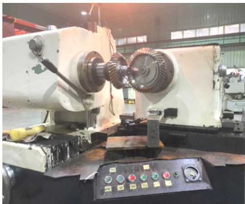
图8 Y9550 数控化锥齿轮滚动检查机
